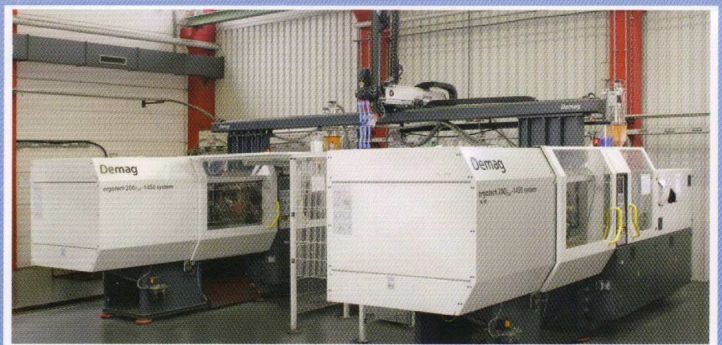
Spritzgussmaschine / injection moulding machine / machine pour moulage par injection
