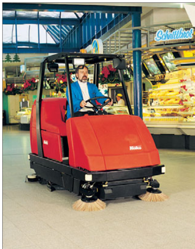
Mit Kehrsaugvorsatz in nur einem Arbeitsgang Kehrsaugen, Naßschrubben und Trockensaugen.
